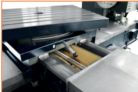
Unidad engranada del mecanismo de la mesa de trabajo giratoria (abajo)
